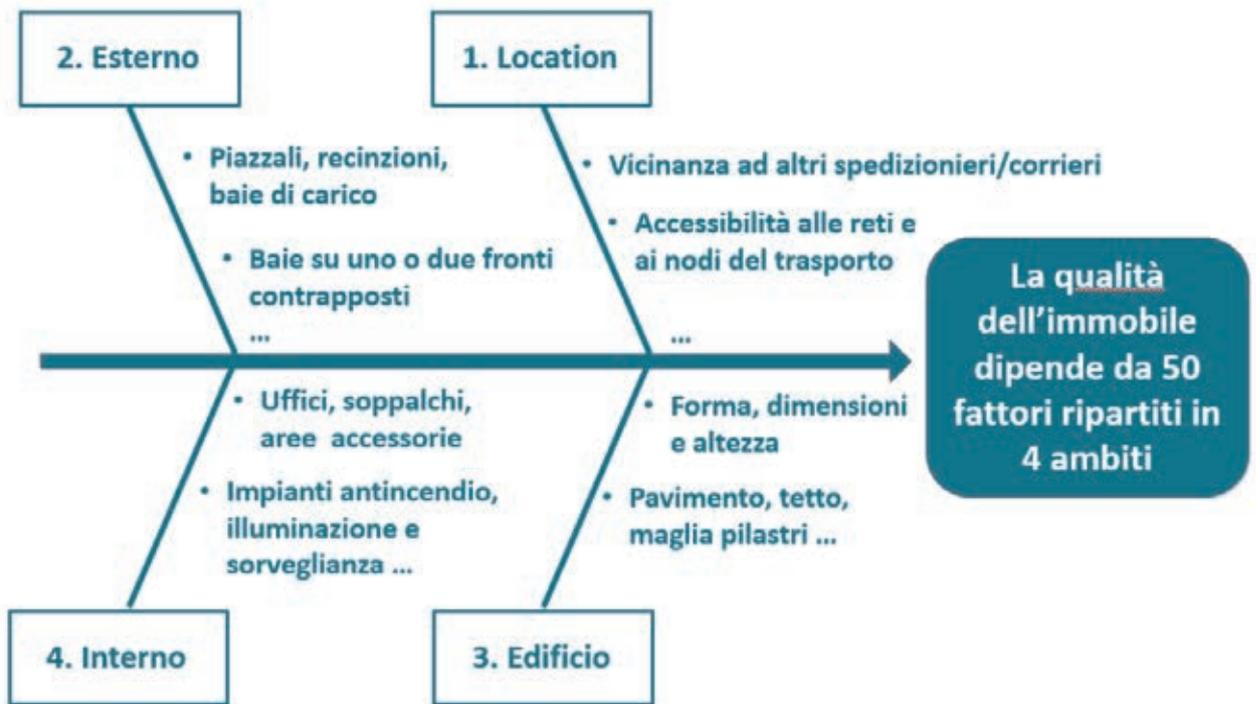
Figura 9: Struttura del sistema di rating per la qualità dei magazzini per gli spedizionieri internazionali.
